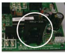
Zabezpieczenie prądowe sprężarki
