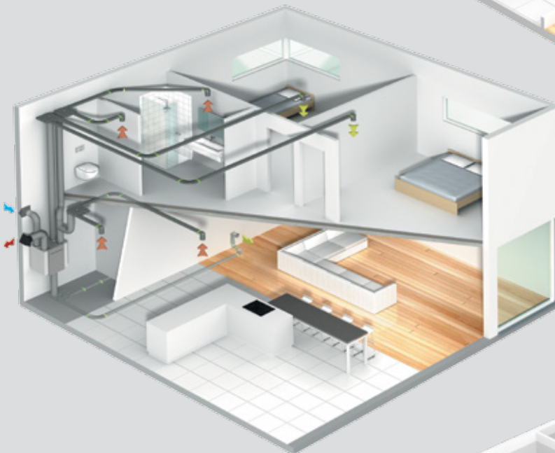
Przykładowy schemat instalacji wentylacyjnej z odzyskiem ciepła z rekuperatorem D300 E II/D400 EP II/D500 E II
